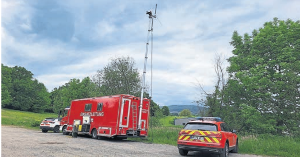
Mit Verstärkern auf Anhöhen wurden im Rahmen der gemeinsamen Übung alternative Funkwege im Kreis Bergstraße getestet.
